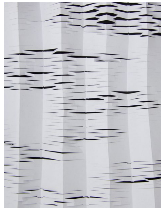
ABB. OBEN UND LINKS: FLÄCHE, DEREN GRÖSSE UND OPAZITÄT SICH ÜBER UNREGELMÄSSIG ANGEORDNETE SCHNITTE VARIIEREN LÄSST. DURCH DEHNUNG ÖFFNEN SICH BEREICHE GEZIELT, ANDERE BLEIBEN DAGEGEN GESCHLOSSEN
