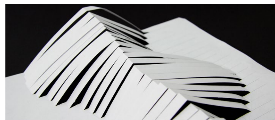
ABB. OBEN UND RECHTS: DURCH DEN VERSATZ DER EINSCHNITTE ERGEBEN SICH UNTERSCHIEDLICHE NEIGUNGSWINKEL IN DER LAMELLENANORDNUNG UND SOMIT VARIABLE ÖFFNUNGEN
