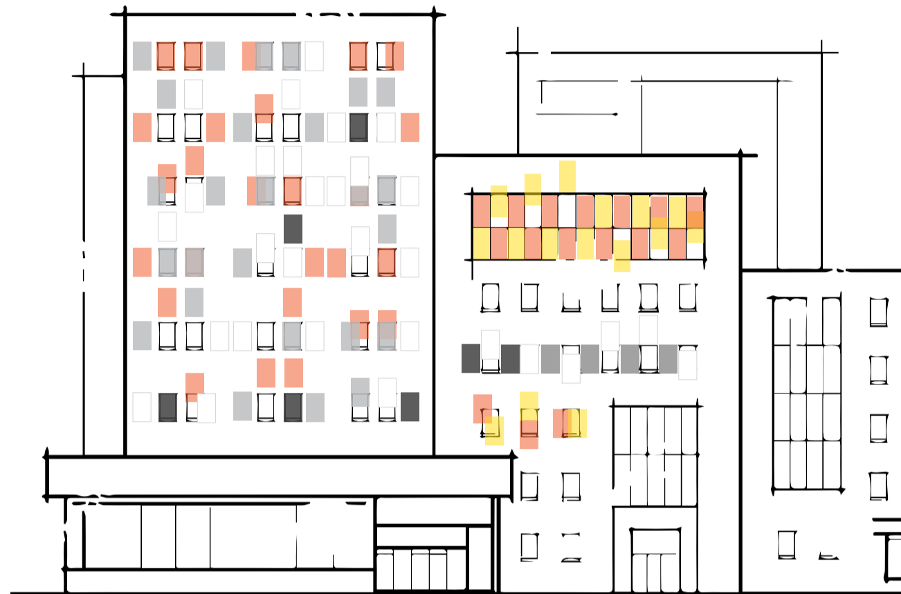
ABB LINKS: SCHEMATISCHE DARSTELLUNG ZUR ANBRINGUNG FALTBARER UND INDIVIDUELL STEUERBARER MODULE FÜR PARTIELLE VERSCHATTUNGSMÖGLICHKEITEN UND BELICHTUNGSSZENARIEN
