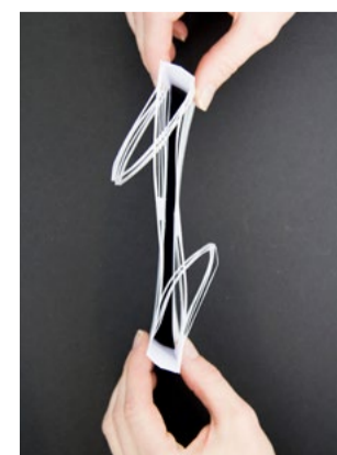
ABB LINKS: FUNKTIONSMODELL EINES REAKTIVEN FASSADENMODULS. DURCH DIAGONALES ANSTEUERN DES FGL-AKTORS WERDEN LAMELLEN GEGENLÄUFIGE AUFGEFÄCHERT.
