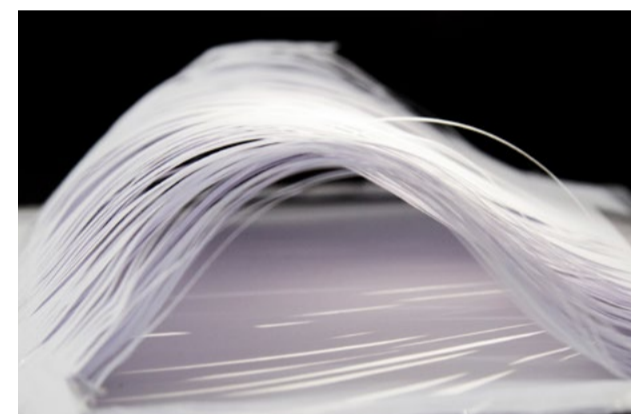
ABB. OBEN, RECHTS, UNTEN: MEHRLAGIGE, SCHMALE UND FLEXIBLE LAMELLEN ERGEBEN EIN VIELSEITIGES SPIEL AUS LICHT UND SCHATTEN. JE NACH KRÜMMUNG DER LAMELLEN UND SONNENSTAND, VERÄNDERN SICH DIE EINFALLENDE LICHTSTÄRKE UND DAS SCHATTENBILD. DURCH DIE MEHRLAGIGKEIT DER SCHMALEN LAMELLEN ERGEBEN SICH SUBTILE NUANCEN ZWISCHEN TOTALER DURCHSICHT, ÜBER DIFFUSES LICHT BIS ZUR VÖLLIGEN VERSCHATTUNG DER FLÄCHE.
