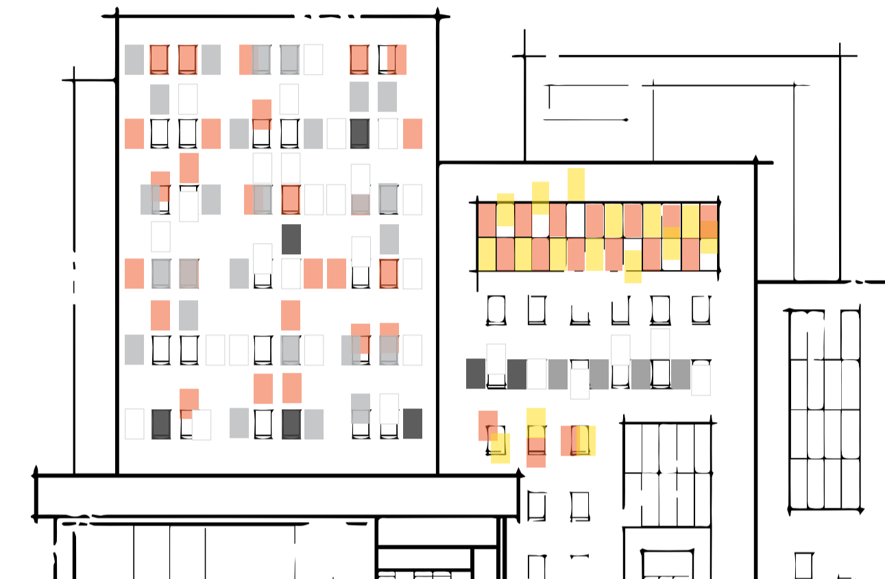
ABB. LINKS: MEHRFARBIGES STREIFENMUSTER IN 3 EBENEN. IM KONZEPT LASSEN SICH DIE FARBSCHICHTEN VERSCHIEBEN UND SOMIT UNTERSCHIEDLICHE FARBGEWICHTUNGEN ERZEUGEN
