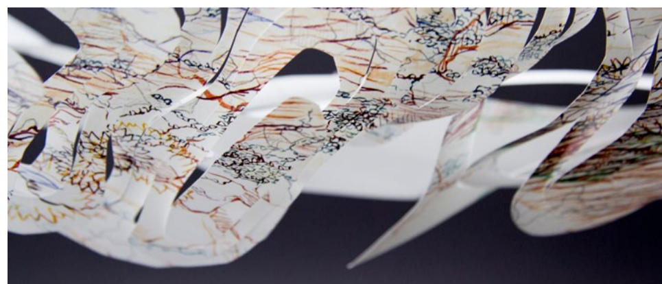
ABB RECHTS: EXPERIMENTELLES MODELL FÜR EINE FGL-ANGESTEUERTE OBERLICHTKONSTRUKTION. DIE ÖFFNUNGEN IN DER FLÄCHE ERGEBEN SICH DURCH ORGANISCH VERLAUFENDE EINSCHNITTE (TOPOGRAPHIEMODELL)
