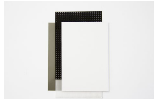
ABB. OBEN: DIE ÜBERLAGERUNG VON MATERIALFLÄCHEN, DIE UNTERSCHIEDLICHE QUALITÄTEN HABEN, WIE FARBIGKEIT (BSP. GRELL, GEDECKT, MEHRFARBIG, EINFARBIG), STRUKTUR (BSP. RAUH, GLATT, GLÄNZEND, MATT), TRANSLUZENZ (BSP. LICHTDURCHLÄSSIG, OPAK) ERMÖGLICHEN EINE GROSSE BANDBREITE AN STEUERBAREM LICHT-EINFALL IM GEBÄUDEINNEREN. DURCH DIE EINSTELLBARKEIT WIRD DAS ERSCHEINUNGSBILD DER FASSADE "INDIVIDUALISIERT".
