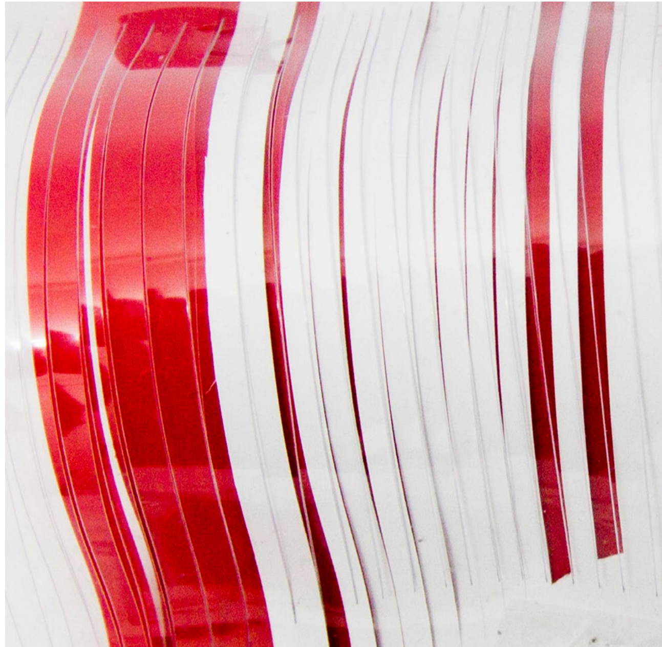
ABB. OBEN: MEHRLAGIGE LINEAR EINGESCHNITTE FLÄCH- EN LASSEN SICH GEGEN- EINANDER VERSCHIEBEN
