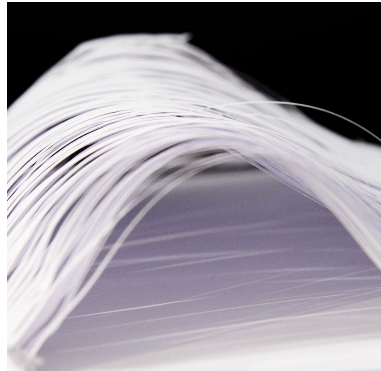
ABB. OBEN, RECHTS, UNTEN: MEHRLAGIGE, SCHMALE UND FLEXIBLE LAMELLEN ERGEBEN EIN VIELSEITIGES SPIEL AUS LICHT UND SCHATTEN. JE NACH KRÜMMUNG DER LAMELLEN UND SONNENSTAND, VERÄNDERN SICH DIE EINFALLENDE LICHTSTÄRKE UND DAS SCHATTENBILD. DURCH DIE MEHRLAGIGKEIT DER SCHMALEN LAMELLEN ERGEBEN SICH SUBTILE NUANCEN ZWISCHEN TOTALER DURCHSICHT, ÜBER DIFFUSES LICHT BIS ZUR VÖLLIGEN VERSCHATTUNG DER FLÄCHE.
