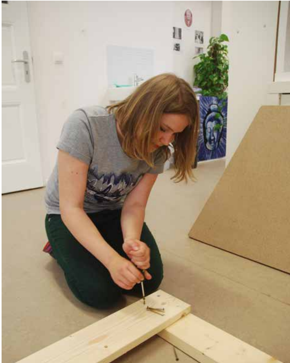
Henrike Mietzfeld schraubt eine Ecke des 320cm x 320cm großen Holzrahmens fest. Rechts neben ihr im Bild lehnt eine schwere MDF-Platte, die den aufgestellten Webrahmen stabilisieren wird.
