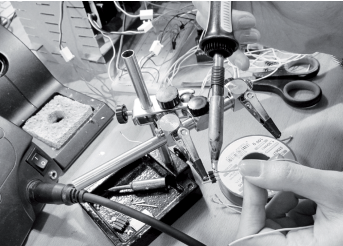
17 Die Enden der verwendeten Kabel für die 26 Servomotoren und den Drucksensor wurden einzeln gelötet, damit sie später mit den Servomotoren verbunden werden können.
