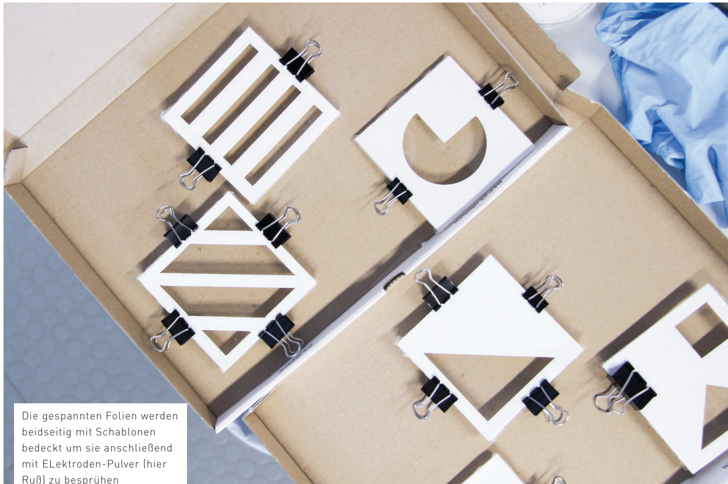
Aufsprühen der Elektrode
