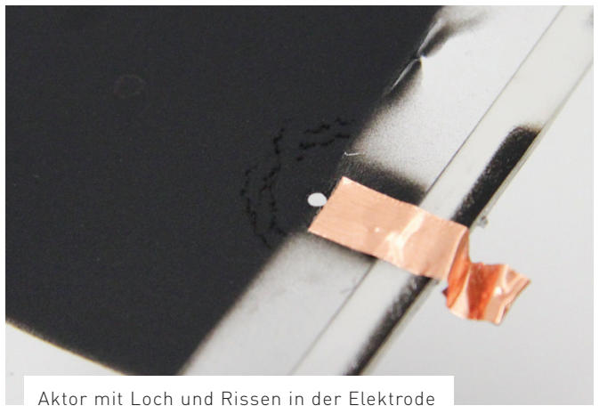
Aktor mit Loch und Rissen in der Elektrode
