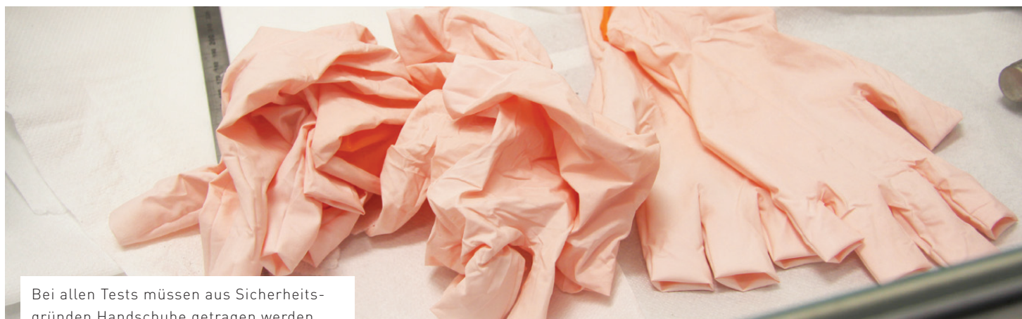
Die gespannten Folien werden beidseitig mit Schablonen bedeckt um sie anschließend mit Elektroden-Pulver (hier Ruß) zu besprühen
