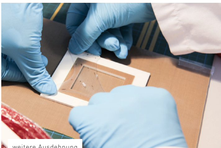
dreidimensionale Verformung des Rahmens durch Zugkraft des Polymerfilms
