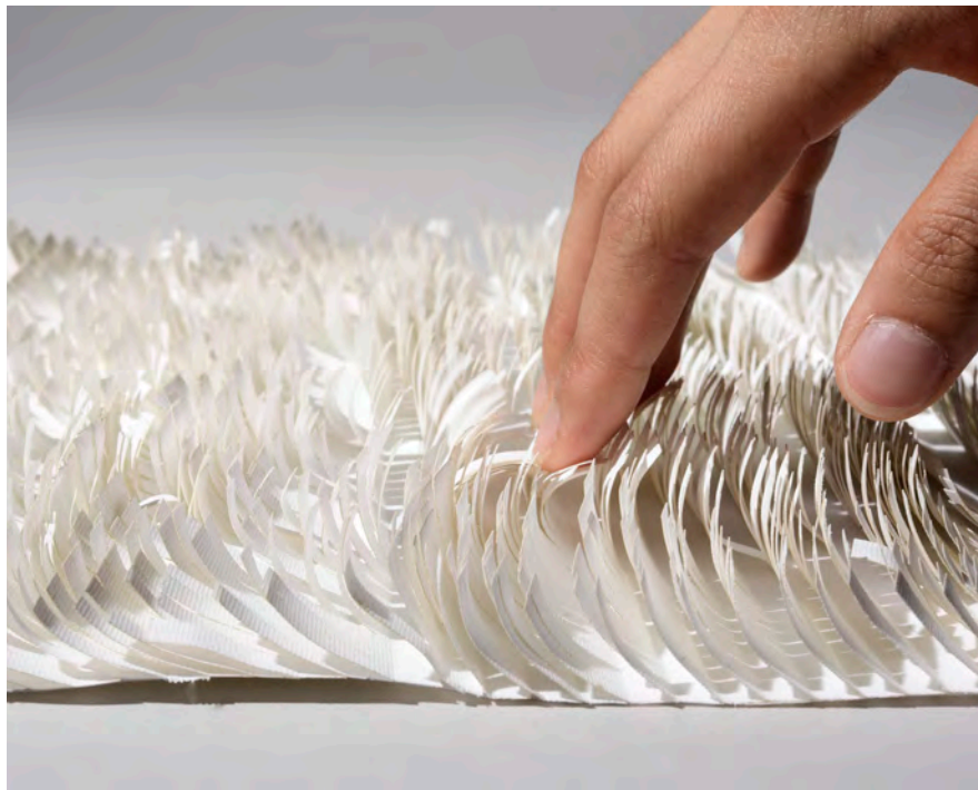
Fiii Shirting 160g s = 0.22 mm, weiß Distanz: 25 mm Höhe: 20 mm Breite: 5 mm
